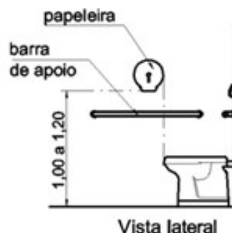
Figura 20 - Imagem referência instalação dispenser
